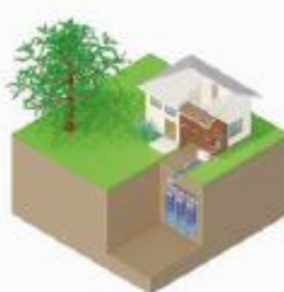
Pompe à chaleur sur corbeilles géothermiques
