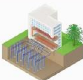
Pompe à chaleur sur sondes géothermiques
