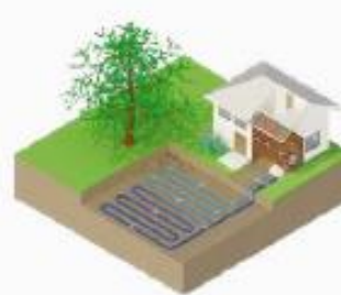
Pompe à chaleur sur capteurs enterrés horizontaux
