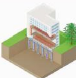
Pompe à chaleur sur géostructures énergétiques
